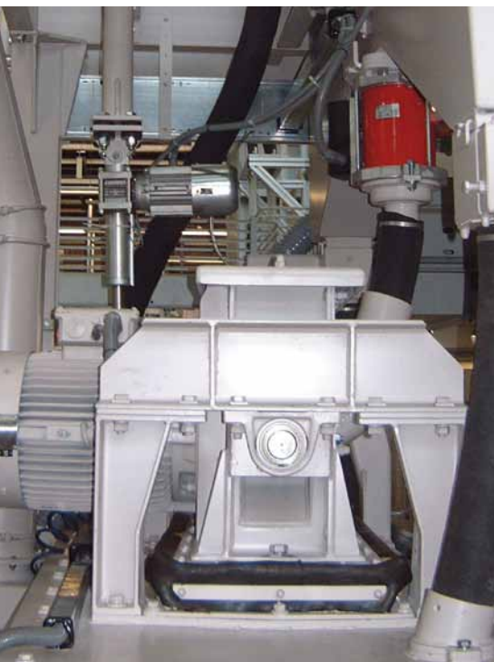
Wysokowydajne turbiny AGTOS w wykonaniu obrotowym na maszynie ze stołem obrotowym i satelitami.
