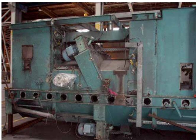
Używana oczyszczarka strumieniowa przed i po przebudowie.
