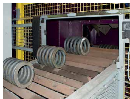
Wlot i wylot oczyszczarki strumieniowej z transportem walcowym do czyszczenia sprężyn śrubowych
