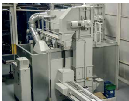
Oczyszczarka strumieniowa z transportem walcowym do utwardzania długich sprężyn spiralnych
