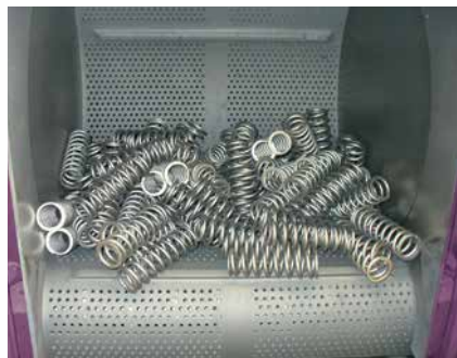
Oczyszczarka strumieniowa z taśmą nieckową do utwardzania sprężyn śrubowych
