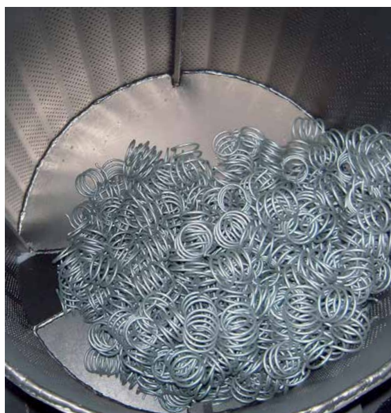
Oczyszczarka strumieniowa bębnowa do utwardzania sprężyn śrubowych
