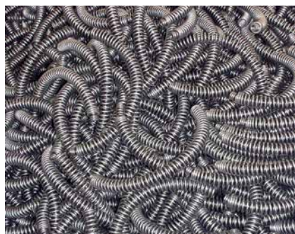
Sprężyny łukowe po oczyszczaniu strumieniowym w oczyszczarce strumieniowej z taśmą nieckową
