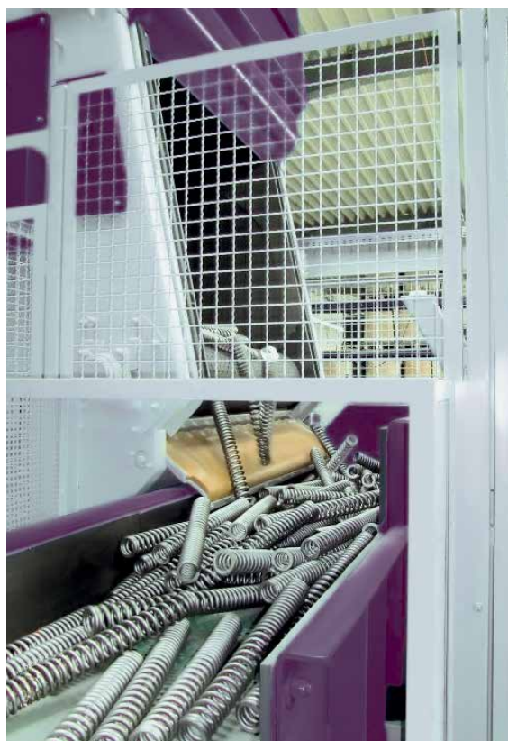
Oczyszczarka strumieniowa z taśmą gąsienicową do utwardzania sprężyn śrubowych
