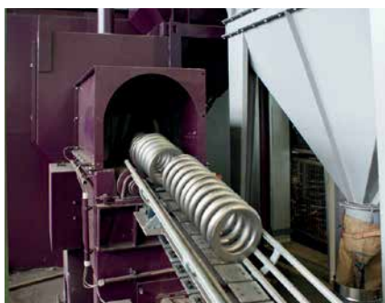
Wlot i wylot oczyszczarki strumieniowej z transportem walcowym do czyszczenia sprężyn śrubowych
