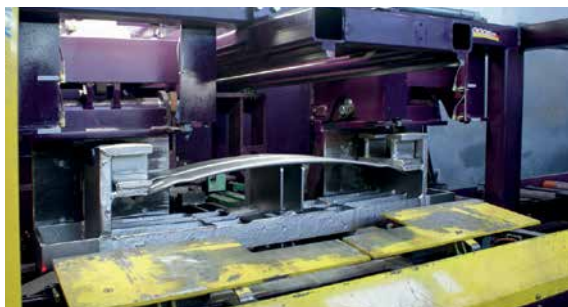
Urządzenie napinające do piór resorów przed obróbką w oczyszczarce strumieniowej z przenośnikiem rolkowym
