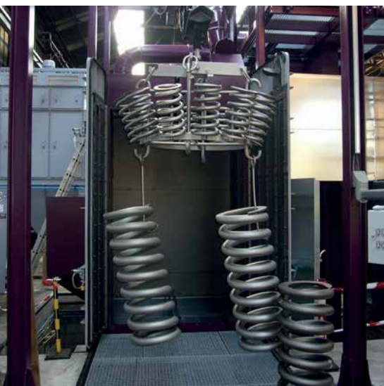
Oczyszczarka strumieniowa zawieszkowa do obróbki sprężyn śrubowych. Wymiary komory obróbki strumieniowej to 1700 x 1700 mm.
