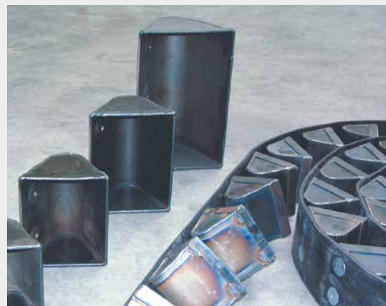
Pasy przenośnika kubelkowego, kubelki i śruby dla wszystkich rodzajów oczyszczarek strumieniowo-ściernych.
