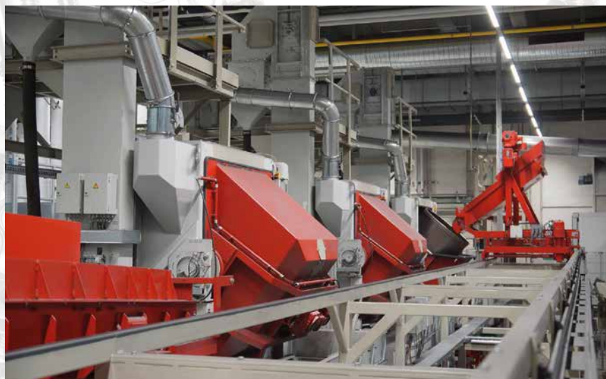
Połączenie w linię umożliwia ciągły proces produkcyjny z bębnowymi oczyszczarkami strumieniowo-ściernymi.
