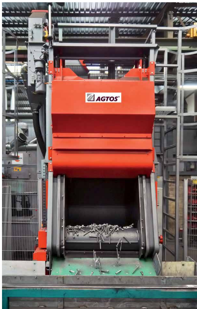
Wyprowadzenie elementów obrabianych na przenośniku taśmowym i przekazanie ich do następnego etapu procesu
