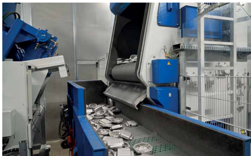
Rozładunek maszyny do obróbki strumieniowo-ściernej i powrót elementów obrabianych do podstawionej skrzynki
