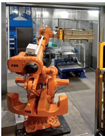
Robot jest centralnym elementem komory obróbki strumieniowo-ściernej.
