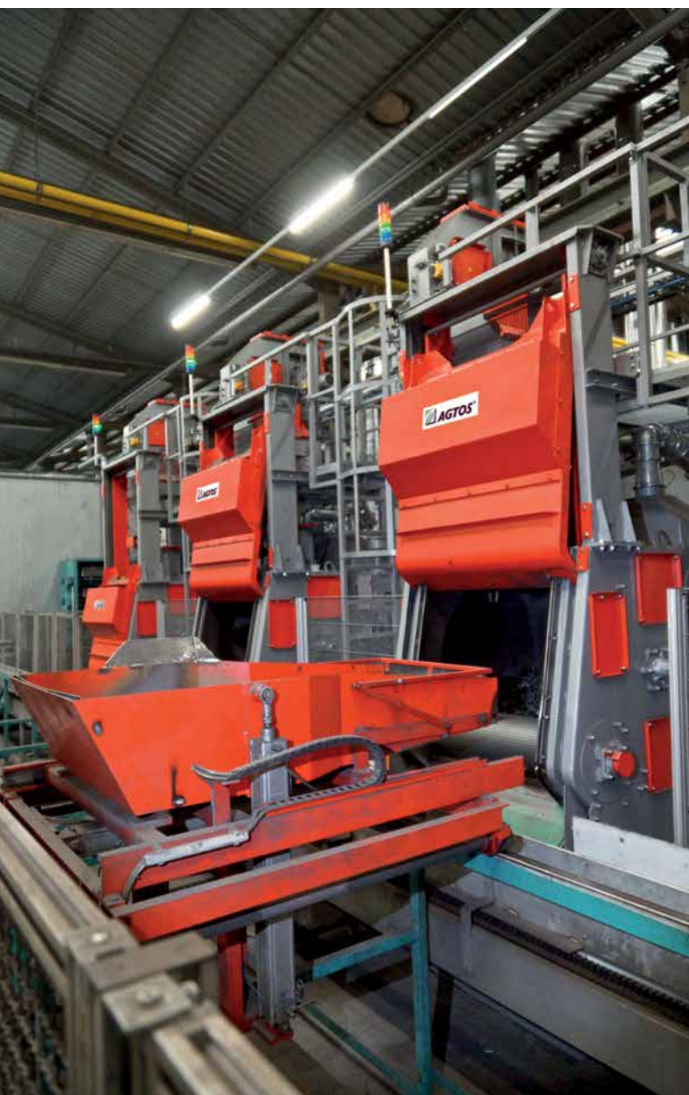
Delikatny załadunek oczyszczarek strumieniowo-ściernych za pomocą urządzenia załadunkowego
