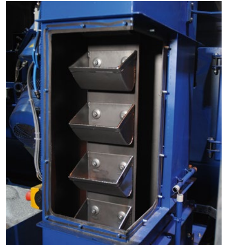
↑ Obszerne klapy serwisowe ułatwiają prace konserwacyjne i nastawcze w oczyszczarce strumieniowo-ścierniej. Fot. Kammermeier
