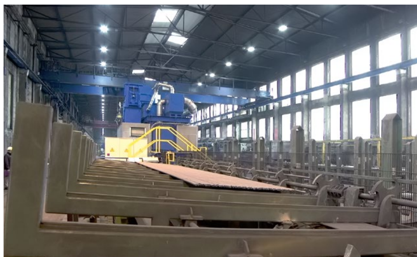
Widok ogólny strony wlotowej oczyszczarki strumieniowo-ścierną AGTOS. Fot. Kammermeier
