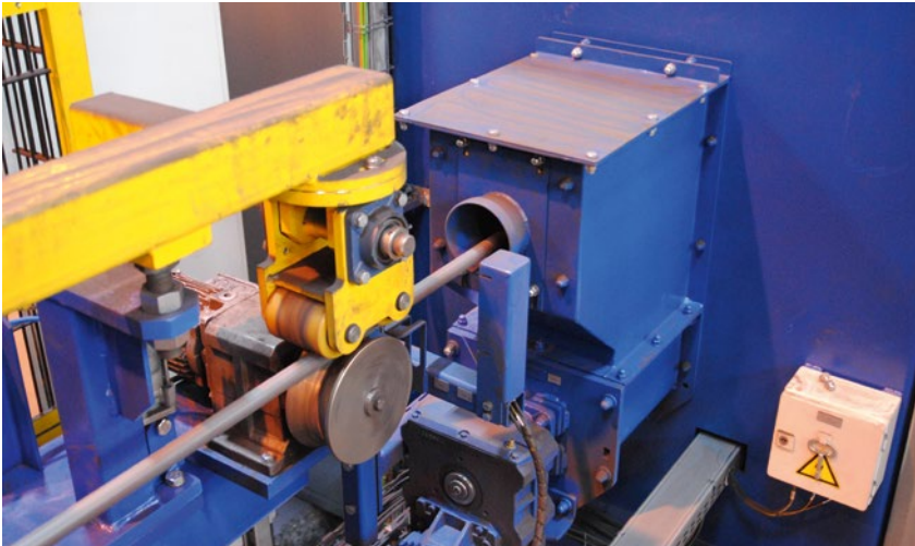
↑ Wlot stali prętowej do oczyszczarki strumieniowo-ścierniej AGTOS. Fot. Kammermeier
