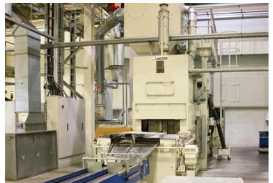
↑ Strona wylotowa jednej z oczyszczarek strumieniowych zainstalowanych w ae w Gerstungen (zdjęcie: Klaus Vollrath).
