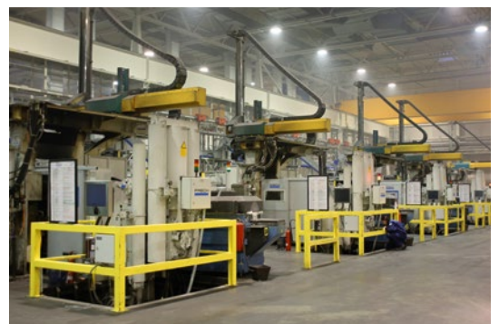
↑ Linia odlewania 2 w końcowym etapie rozbudowy zawiera łącznie siedem zimnokomorowych maszyn odlewniczych dla aluminium (zdjęcie: Klaus Vollrath).
