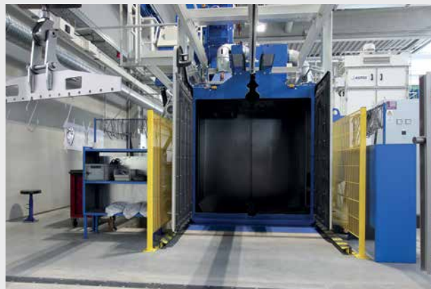
W oczyszczarce zawieszkowej AGTOS typu HT 17-17 małe części mogą być oczyszczane automatycznie.
