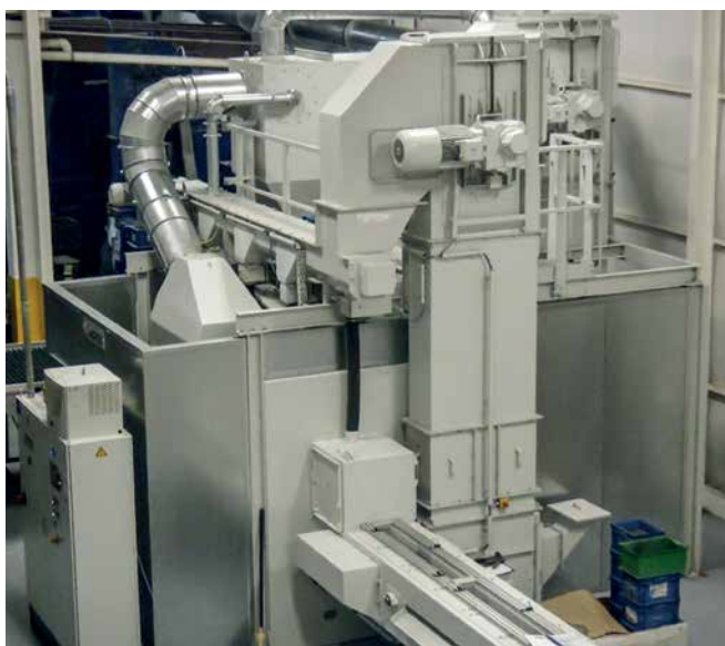
Oczyszczarka strumieniowo-ścierna z transportem walcowym do utwardzania długich, niestabilnych sprężyn spiralnych
