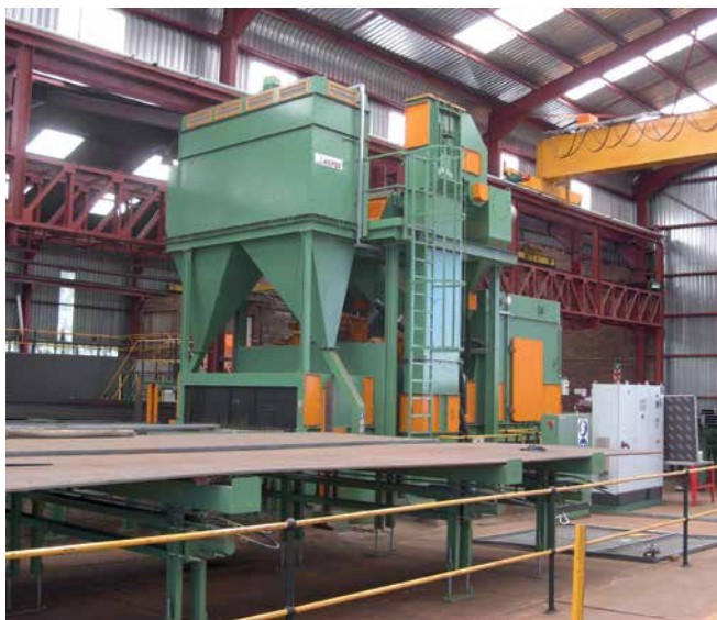
Oczyszczarka strumieniowa z przenośnikiem rolkowym AGTOS typu RT 26 do oczyszczania i usuwania zgorzeliny z blach i kształtowników.
