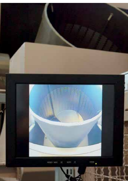
Załadunek i rozładunek może być monitorowany z pozycji szafy sterowniczej za pomocą kamery wideo
