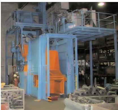
Oczyszczarka strumieniowa z taśmą stalową (Odlewnia Żeliwa, Lisie Kąty, Polska).
