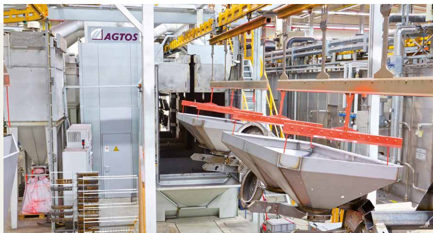
▲ Ilustracja 5: Oczyszczarka strumieniowa wykorzystana przy produkcji maszyn przeznaczonych do dozowania i rozsiewania nasion.
