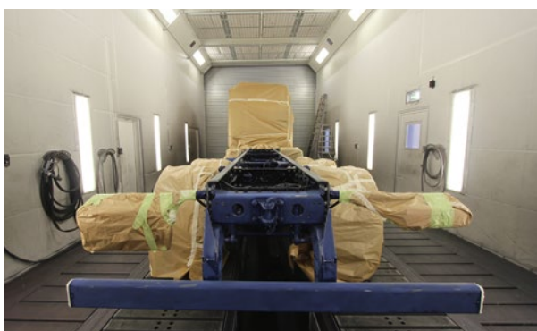
↑ Sekcyjny system napowietrzający w kabine lakierniczej firmy SLF pozwala oszczędzać energię.
