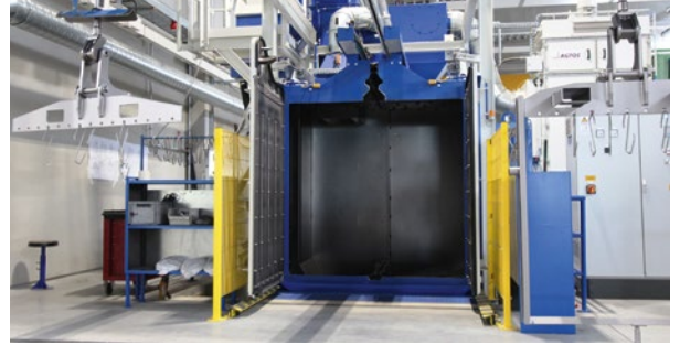
↑ Urządzenie zawieszkowe do obróbki strumieniowej typu HT 17-17 firmy AGTOS umożliwia automatyczną obróbkę małych przedmiotów.
