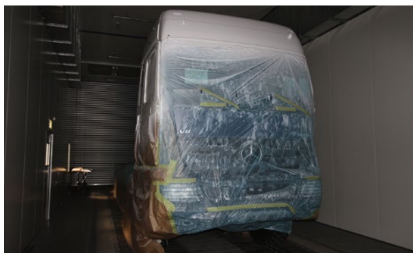
↑ W suszarni odbywa się suszenie przy 70°C. Wjazd możliwy jest również od strony kabiny lakierniczej.
