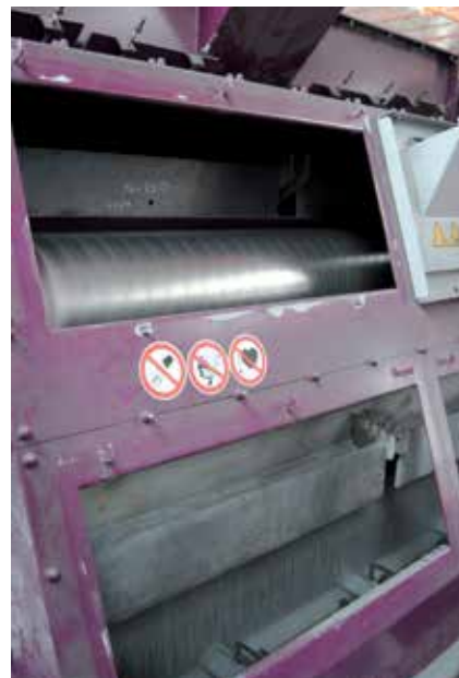
Separacja magnetyczna/powietrzna z wałkiem magnetycznym i strumieniem ścierniwa
