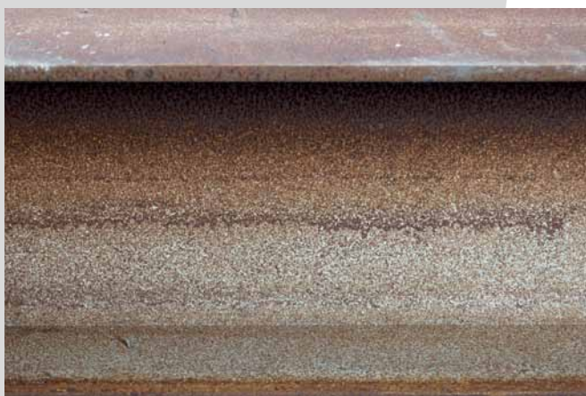
Dwuteownik przed obróbką strumieniową...
