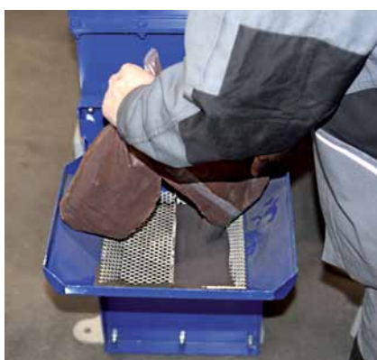
Wygodny silos do dosypywania ścierniwa
