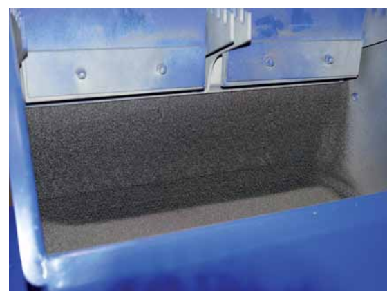
Separator powietrzny usuwa pył i podziarno ze ścierniwa.
